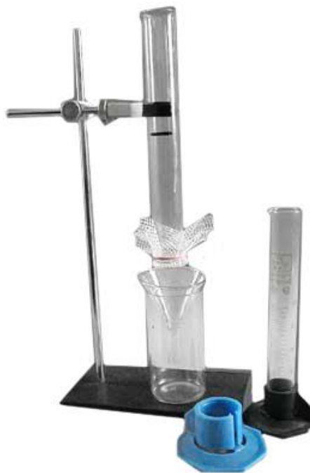
Рис. 4. Установа для визначення водопровідності ґрунту.
