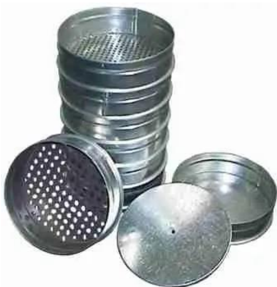
Рис. 3. Набір сит для визначення структурного складу ґрунту.
